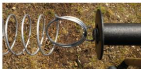
**3. El aislador tiene 2 extremos** (es decir, dos anillas): una anilla es para enganchar el muelle a dicho aislador y la otra es para conectar el cable conductor de la cerca al aislador. Por lo tanto:
