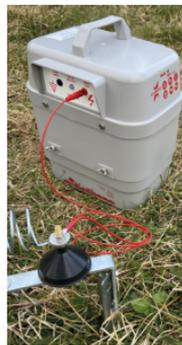
C. Si el pararrayos está sujeto a una pared, se debe colocar una toma de tierra. Para ello, el tercer cable que hay en el pararrayos lo conectamos a una pica de toma de tierra (sin embargo, si el pararrayos está sujeto a un poste de metal, no es necesario conectar este tercer cable).
