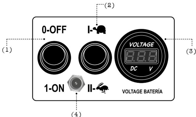
(1) Interruptor de encendido (posición 1-ON) y apagado (posición 0-OFF) para poner en marcha o apagar el pastor.
