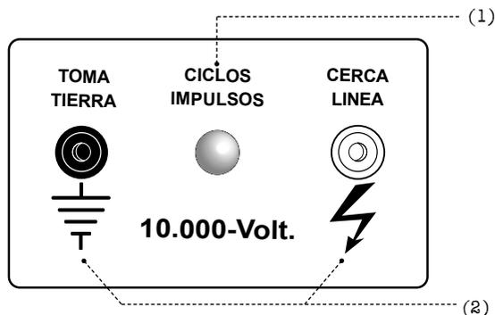
(1) Indicador de impulsos: Se ilumina siempre que el pastor dé un impulso de tensión a la cerca, verificando así su funcionamiento.
