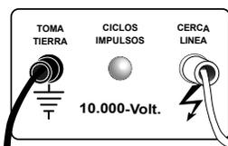
PASO 4. Conecta el extremo libre del cable negro a la pica de toma de tierra y el extremo libre del cable rojo a cualquiera de los conductores positivos de la cerca.
