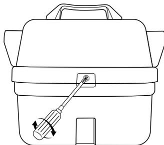
**NOTA:** Para sustituir el fusible, utilizar SIEMPRE un fusible de 8 ó 10A.
